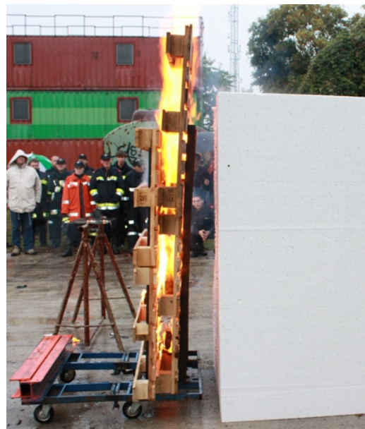
Foto: Brennende Holzpaletten vor Block aus Baustyropor
