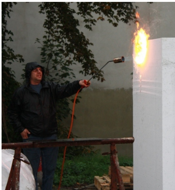
Foto: Block aus Baustyropor durch Flämmer beansprucht
