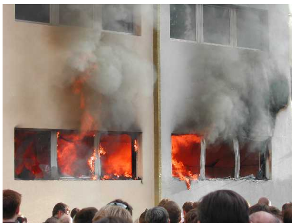
Foto: Fassadenbrandtest (27. Prüfminute)
